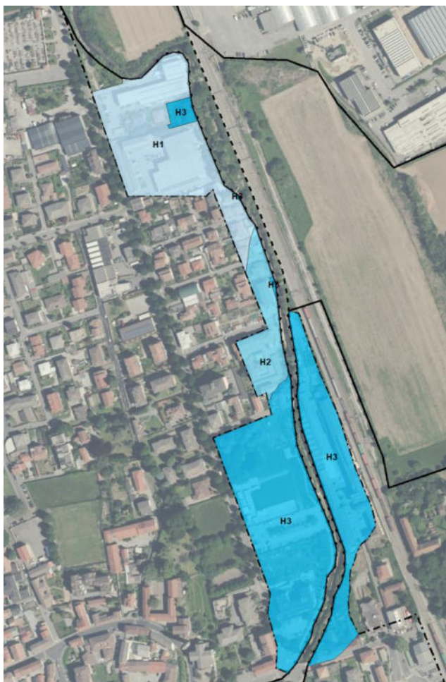
Figura 65. Area a Sud del cimitero comunale: Pericolosità idraulica
