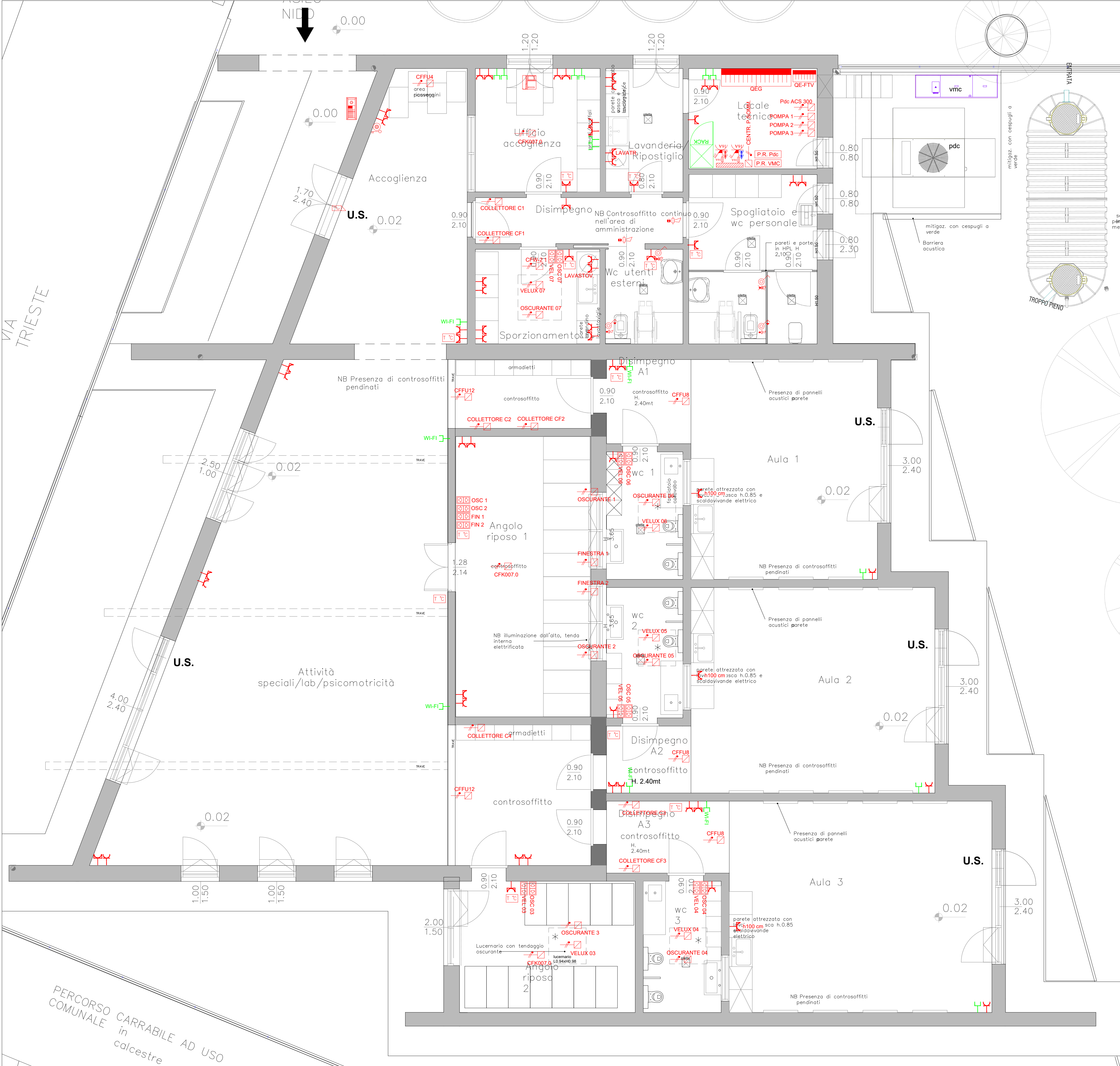
PLANIMETRIA IMPIANTO FORZA MOTRICE - TRASMISSIONE DATI scala 1:50
